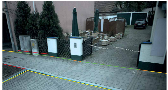
Für die Überflutungsanalyse in Röthenbach wurden zentimetergenaue Informationen zur Straßengeometrie mit der adaptiven Befahrungstechnologie der eagle eye technologies GmbH erstellt.
